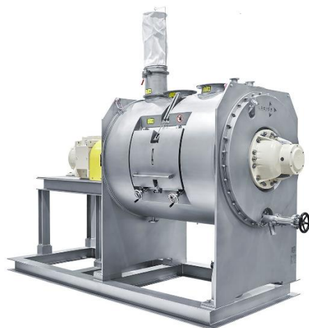
Abbildung 1: Pflugschar®-Mischer Typ FKM 3000 zum Conchieren von Schokolade mit Temperiermantel und hygienisch verschweißter Isolierung
