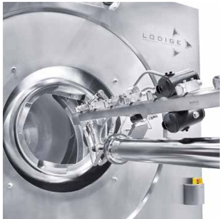
Düsarm mit Sensoren zum Messen von Abstand und Winkel zum Tablettenbett
