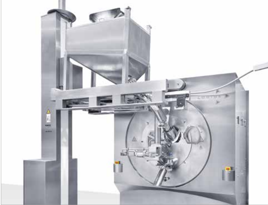
Befüllung des Coaters mittels Hubsäule
