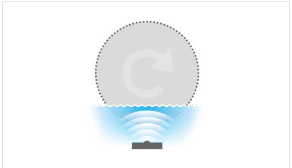
Für die schnelle Reinigung der Trommelperforation kann bei der LC-Baureihe ein Ultraschall-Generator in das Reinigungssystem integriert werden.*
