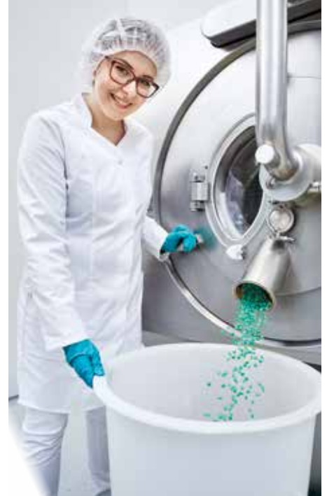
Entleerung des Coaters über den Auslauf an der Coater-Front
