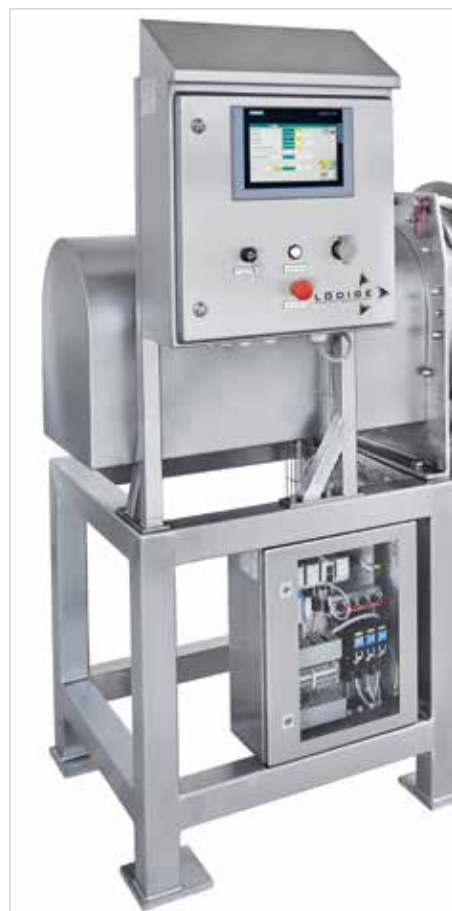
Hygienische Ausführung von Dichtungsserviceeinheit und Steuerstelle
