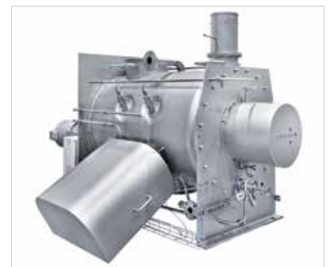
Abdeckhauben über Lagergehäuse und Motoren schaffen leicht zu reinigende Oberflächen
