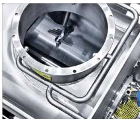
Reinigungsdüsen für die WIP-Reinigung
