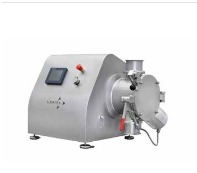
Labor Pflugschar®-Mischer mit Wechseltrommeln
