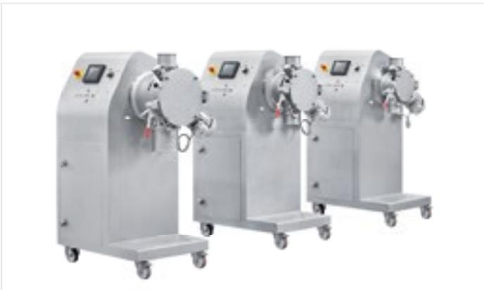
Pflugschar®-Mischer (Labormaschine) mit feststehendem Behälter, Größen 5, 10, 20 l, optional mit Unterbau
