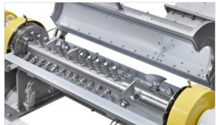
Bei wässrigen Flüssigkeiten kann die Zugabe der flüssigen Komponente durch die Mischwerkzeuge zugeführt werden.
