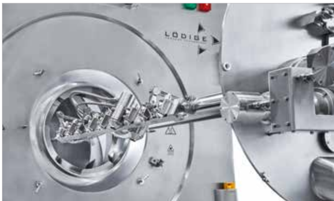
Lödige Coater Typ LC 150 mit ausgefahrenem Düsarm
