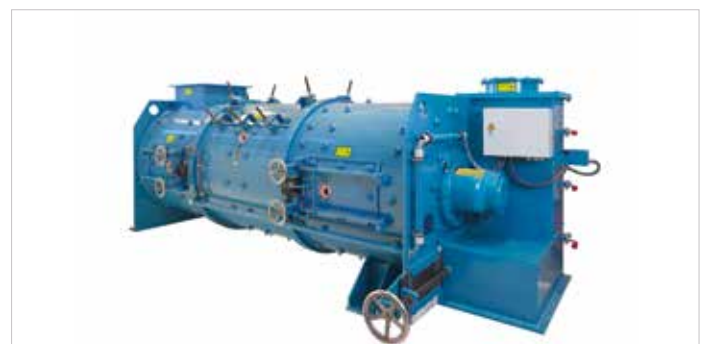
Lödige Pflugschar®-Mischer für kontinuierlichen Betrieb Typ KM-D, Sonderausführung mit austauschbarer Verschleißauskleidung
