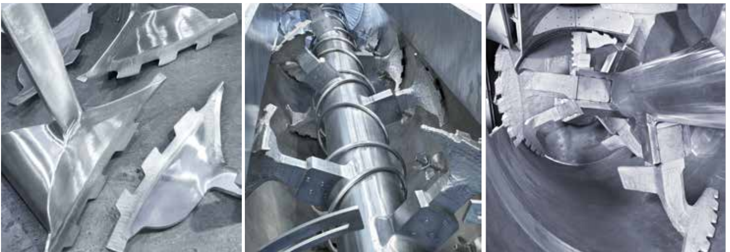
Mischelemente in Stollenausführung optimal auf die Aufgabenstellung angepasst
