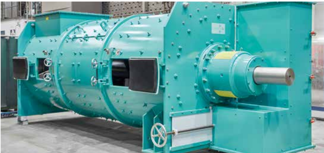
Lödige Pflugschar®-Mischer für kontinuierlichen Betrieb: mit Gummi-Auskleidung als Verschleißschutz für die Vermischung von Eisenerz
