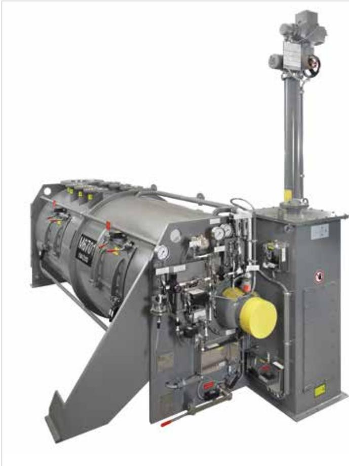
Pflugschar®-Mischer für kontinuierlichen Betrieb Typ KM 4200 in explosionsgeschützter Ausführung zur Basisstabilisierung von Polyolefinen
