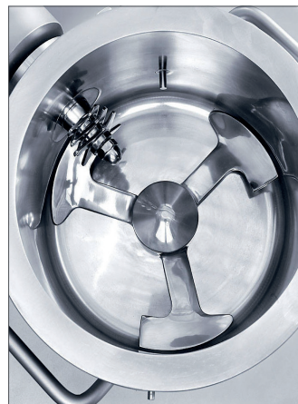
Blick in den Mischaum des 5 l Behälters mit Messerkopf
