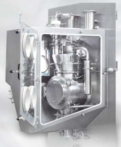
Mischtrockner als Containment-System.
