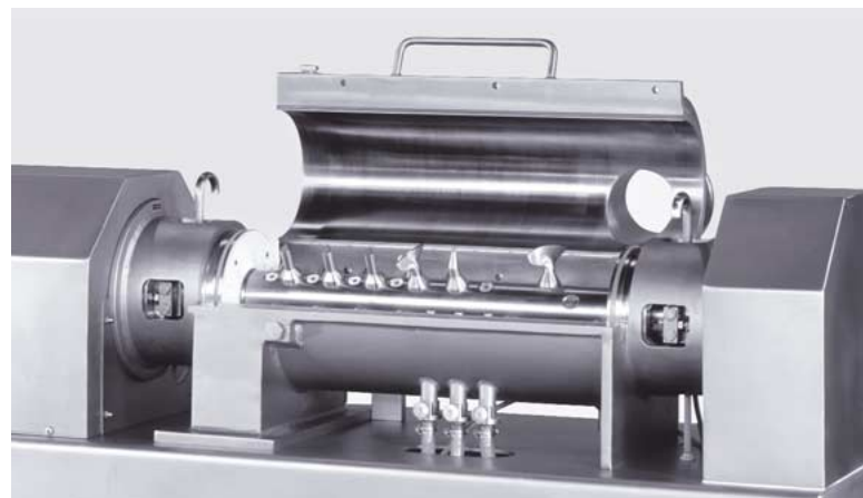
Kontinuierliche, hohtourige Mischer Typ CoriMix®-Pharma für den primären Einsatz bei Befeuchtungs- und Granulierprozessen.
