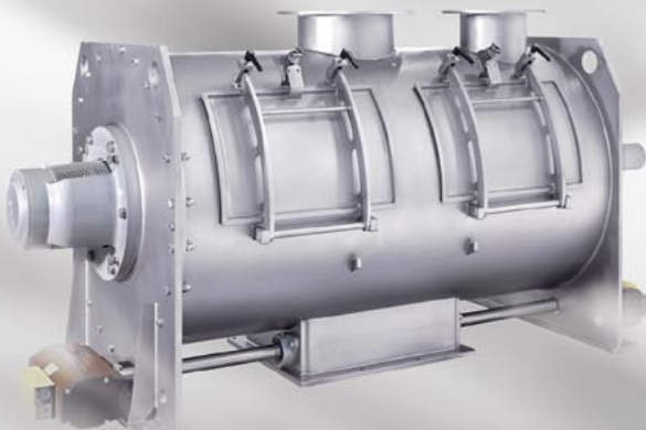
Pflugschar® - Chargenmischer für die Aufbereitung von metallischen Pulvern/NE-Metallen mit sehr hohen Schüttgewichten; verstärkter Antrieb, verstärkte Konstruktion
