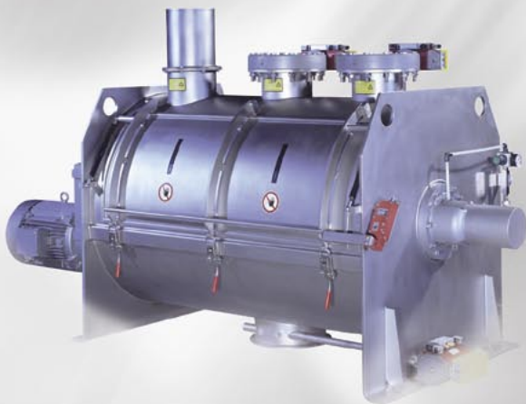
Pflugschar® - Mischer für die Aufbereitung von Rohstoffen für hochwertige Gläser; innerer Trommelbereich sowie komplettes Schleuderwerk mit Aluminiumoxidkeramik- Beschichtung
