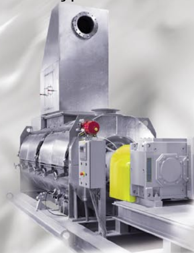
Kontinuierlicher Mischer zur Kühlung von Anodenmassen. Mischer mit Isolierung, Infrarot-Temperaturmessung, Brüdenschacht und großen Inspektionsklappen.
