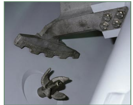
Stollenschaufel und Messerkopf mit kompletter Spezial-Hartmetallaufschweißung
