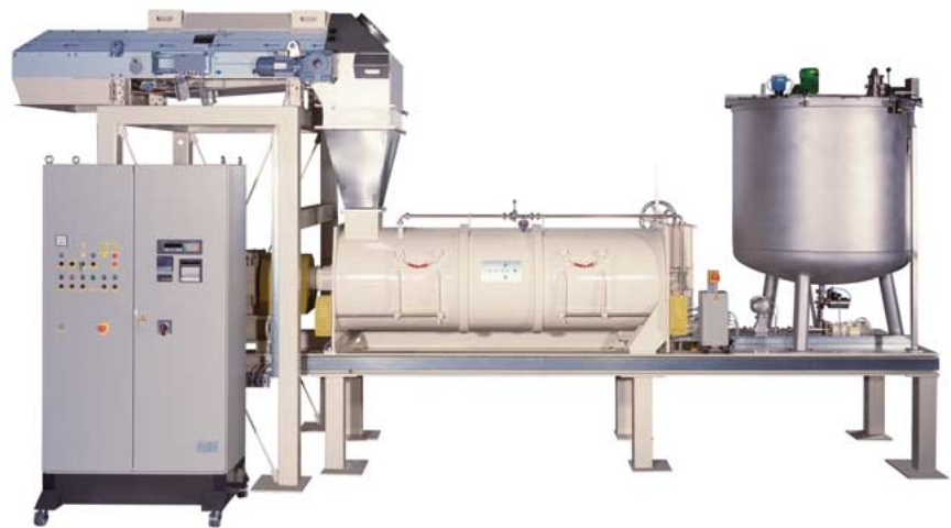
Kontinuierliche Anlage zur Salzaufbereitung mit Verwiegung und Dosierung
