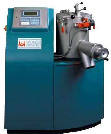
Labor- Schnellmischer System Papenmeier® Typ TGHK 20. Vertikales System
