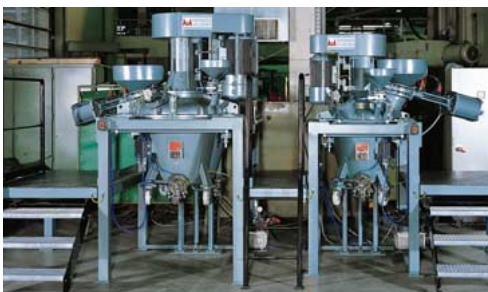
Reinigungsfreundliche Produktionsanlage mit absenkbaaren, fahrbaaren Mischbehältern.
