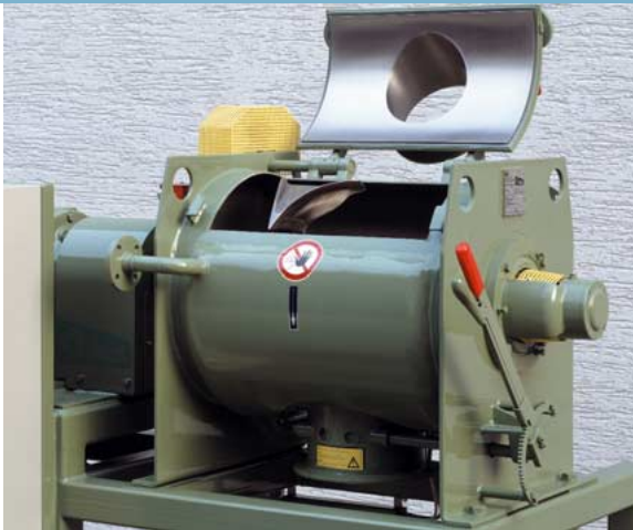
Chargenmischer für Handbeschickung und rein manuellen Betrieb; Typ FM 130
