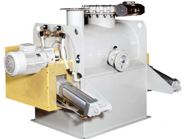
Chargenmischer Typ DBE 600 mit grosser, patentierter Entleerungsklappe
