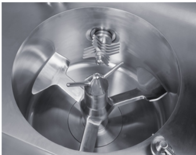
Mischwerkzeug zur Inspektion angehoben
