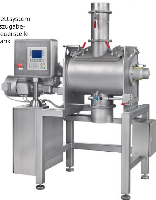
Pflugschar®-Chargenmischer mit Pflugschar®-Schleuderwerk, Messerkopf und Lanze
