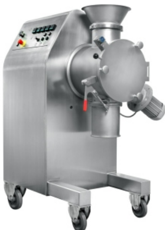
L 50 mit einseitig gelagerter Mischwerkzeugschleuder
