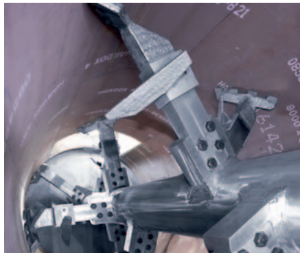
Behälter mit metallischer Auskleidung
