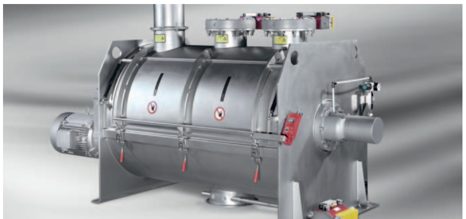
Pflugschar®-Mischer für die Aufbereitung von Rohstoffen für hochwertige Gläser; innerer Behälterbereich sowie komplettes Mischwerk mit Aluminiumoxidkeramik-Beschichtung
