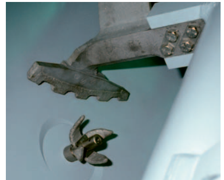
Stollenschaufel und Messerkopf mit kompletter Spezial-Hartmetallaufschweißung
