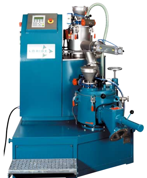
Combinaison de mélangeurs chauffant / refroidissant TGHK / KGU, système Papienmeier®
