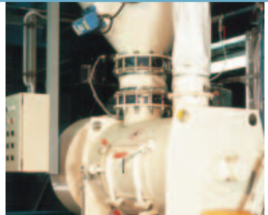
Mélangeur par charges pour alimentation automatique ou semi-automatique avec raccordement pour alimentation ; type FKM 300
