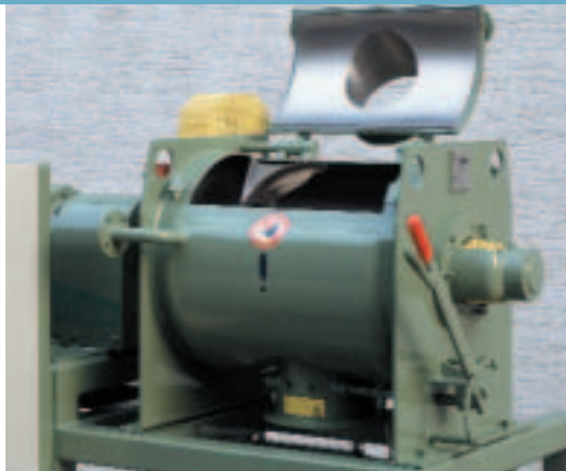
Mélangeur par charges pour alimentation manuelle et fonctionnement uniquement manuel ; type FM 130
