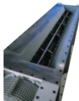
Ecluse rotative à 12 chambres
