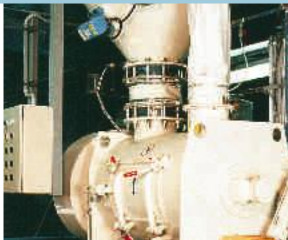
Порционный смеситель для автоматической или полуавтоматической загрузки с соединительной системой; тип FKM 300
