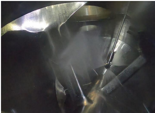
Rotationsreiniger mit Flachstrahldüsen in einem 10.000 l Lödige Pflugschar®-Mischer in Betrieb. (Quelle: Lödige Process Technology)
